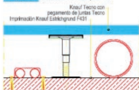
F181-V4 Diseño para instalaciones
